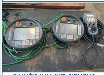
PAINÉIS IHM (HT) SIEMENS
